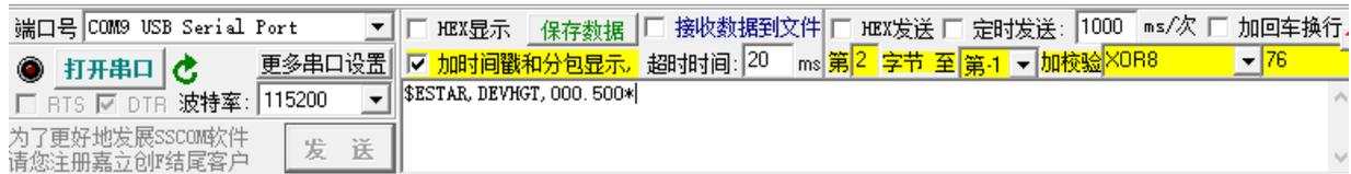
图 6-2 通过串口配置设备安装高度
