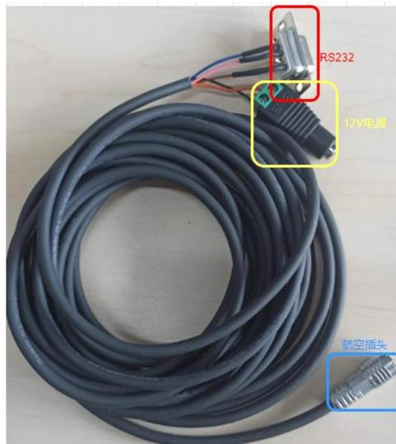
图 6-1 设备航插转接线的连接
